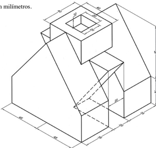
3. [3 PUNTOS] En la perspectiva de la **figura 2** se representa la perspectiva isométrica de una pieza que tiene dos planos de simetría verticales. (Se dibujan en la perspectiva sólo las líneas ocultas imprescindibles para la correcta interpretación de la pieza).
